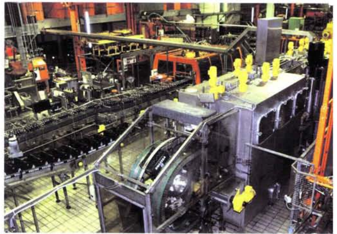
Direkt nach der Einfahrt in den Kastenwascher wird jeder einzelne Kasten sofort fixiert und zunächst gewendet. Dabei fallen alle losen, groben Fremdkörper heraus.
